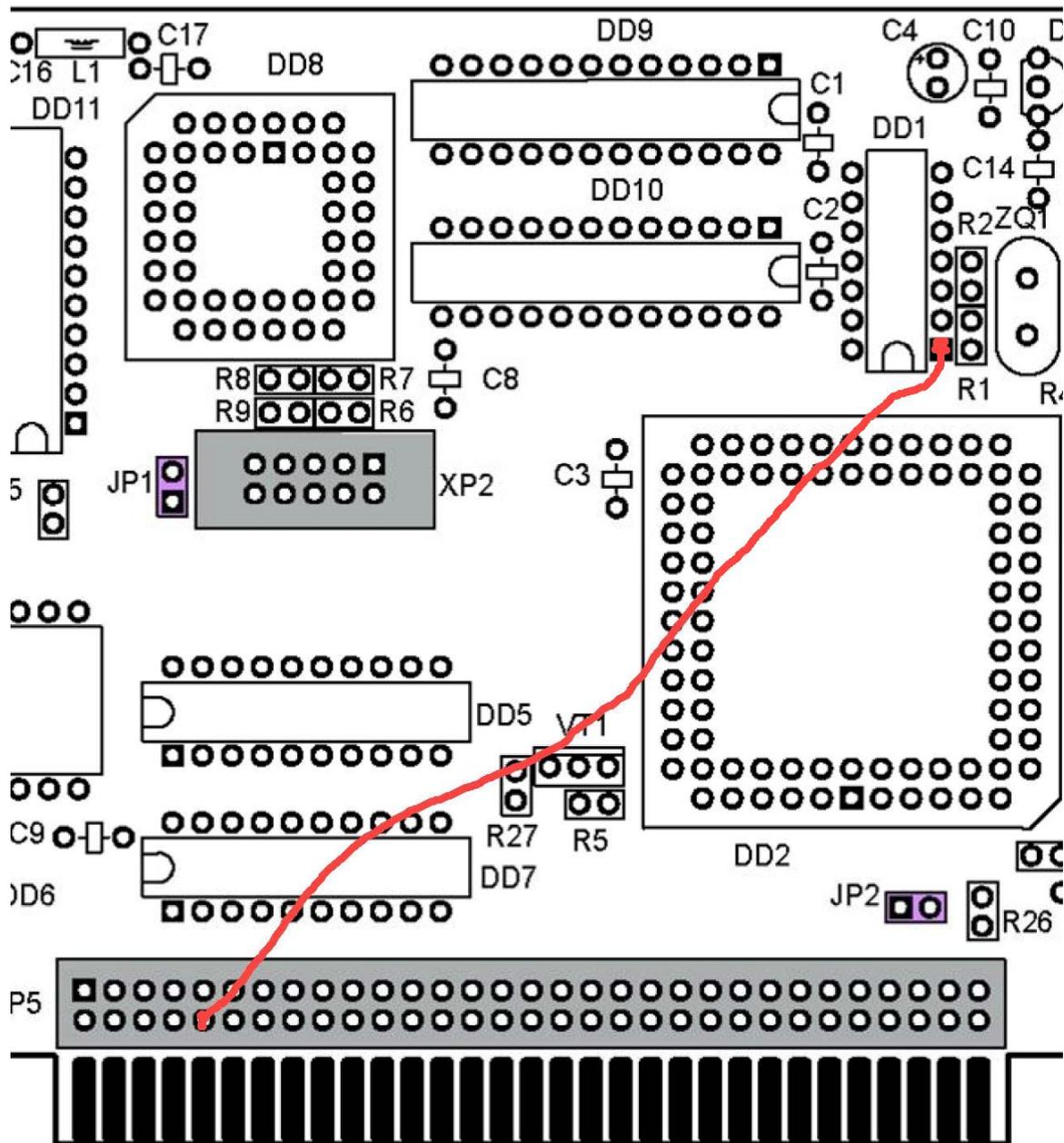
Примечание: После проведения доработки необходимо заменить прошивки микросхем DD2 (хранится в микросхеме DD4) и DD8 на версии 02.00 или выше.
